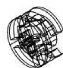
D14*5 Eccentric wheel + Eccentric rod combination
